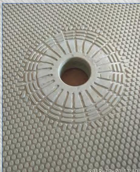
На данном примере видно, что в ходе ремонта была видоизменена форма узора фильтратоотводящих каналов с целью усиления мест износа плиты.
