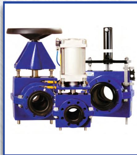
SMART Valve™ датчик, вмонтированный в каждую трубку, автоматически сигнализирует, когда требуется произвести замену трубки, что дает экономию средств, которые нужно было бы затратить при неожиданных поломках клапана. Эластомерная трубка является единственной частью, которая соприкасается с производственным потоком. Трубка меняется без помощи каких-либо специальных приспособлений или навыков. Это на 70% уменьшает стоимость технического обслуживания.
