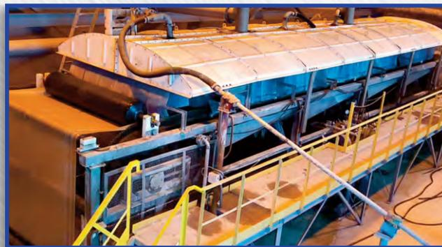
На вакуум-фильтрах применена система опускания вакуум-камеры, для удобства замены ее уплотняющих ремней. В зависимости от ширины ленты вакуум-фильтра используются роlikоопоры или система опоры с воздушной подушкой. Такая опора для дренажной ленты обеспечивается за счет нагнетания сжатого воздуха через воздушный короб.
