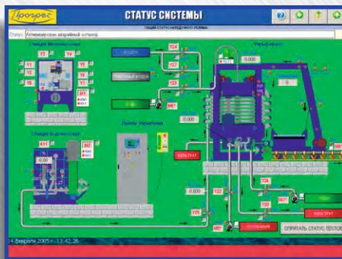
Водонасосная станция предназначена для подачи воды под давлением на отжимные диафрагмы (мембраны), с целью уменьшения влажности осадка. Водонасосная станция комплектуется вертикальным центробежным насосом и приборами управления.
