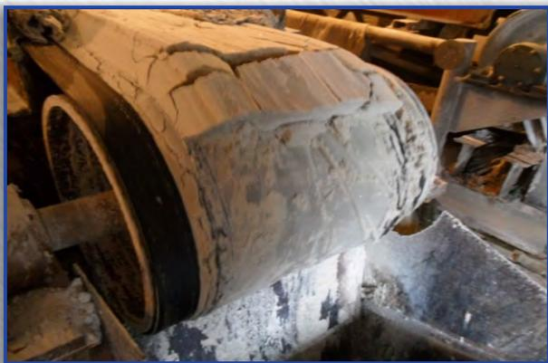
Фильтры вакуумные ленточные предназначены для разделения агрессивных и неагрессивных быстро осаждающихся суспензий с неоднородной твердой фазой.
