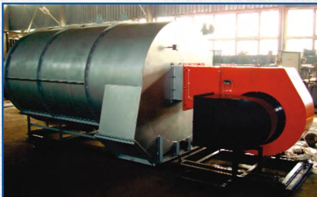
Сушильные установки комплектуются теплогенераторами ТГ мощностью от 0,12 до 34, 42 МВт. Теплоноситель создается в теплогенераторе, путем сжигания топлива (природного газа или жидкого, твердого топлива), а потом разбавляется атмосферным (подготовленным по требованию) воздухом до определенной температуры. Подготовленный теплоноситель поступает в сушильный барабан определенной температуры.
