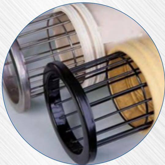
Металлический каркас предназначен для придания и фиксации оптимальной формы рукава фильтровального при фильтрации и регенерации, что необходимо для обеспечения стабильного рабочего процесса.
